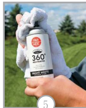
5 當噴塗完每一洞口後，一定要清潔與擦拭噴漆頭確保噴頭不會阻塞。
