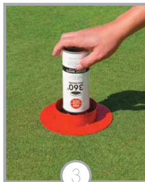
3 噴漆頭置於噴塗工具中心點，下壓三至四次（每次約一秒） 注意：不需要旋轉瓶身
